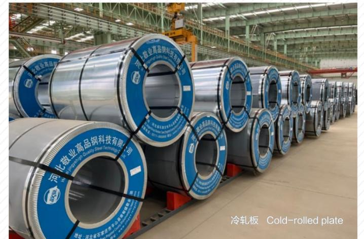
冷轧板 Cold-rolled plate
