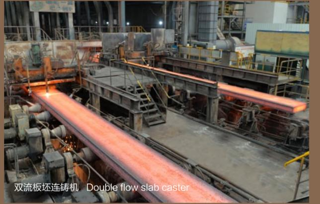
双流板坯连铸机 Double flow slab caster
